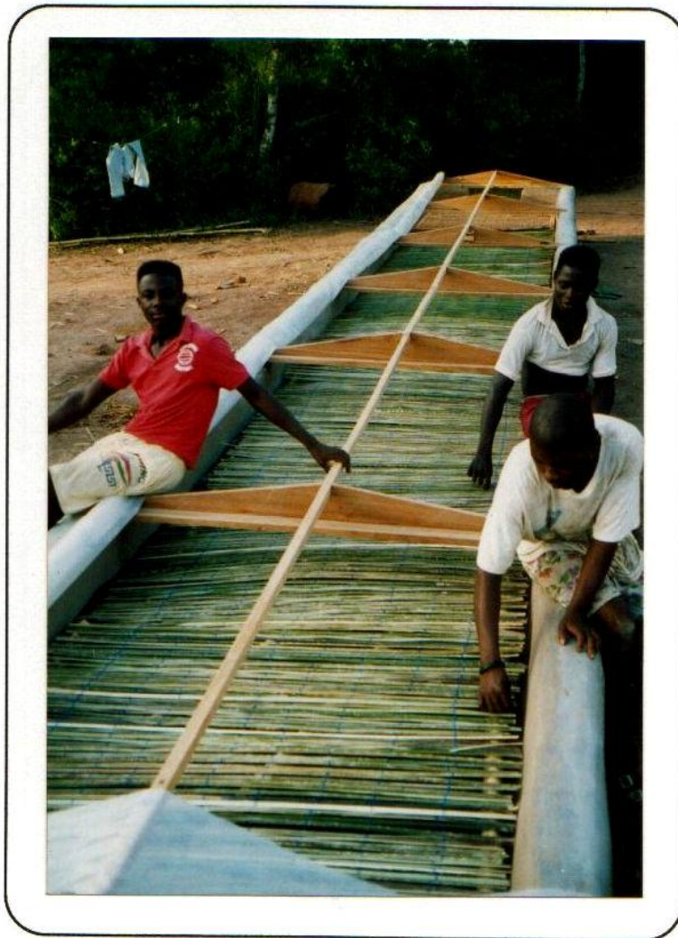
Le support pour les denrées à sécher est constitué d'une natte de bâtons de palmiers fait avec un métier simple.
