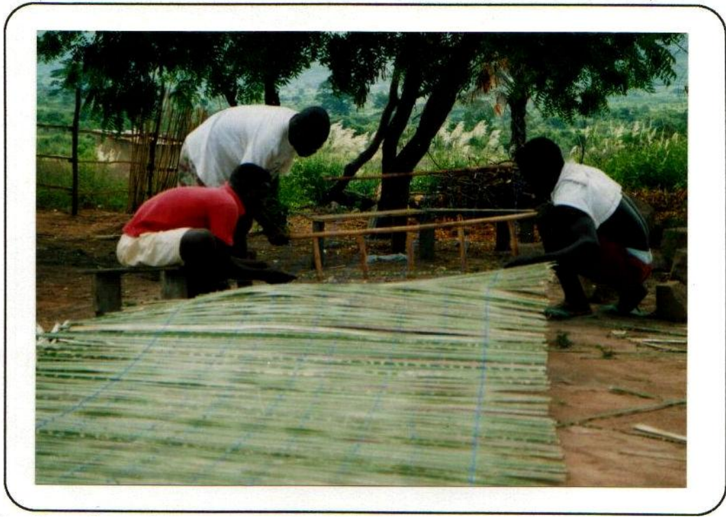
Le support pour les denrées à sécher est constitué d'une natte de bâtons de palmiers fait avec un métier simple.
